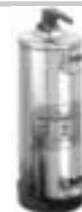
Depurador 12 litros Inoxdep con tapa de leva. Ø 180 mm. Altura 560 mm. Sal regeneración 2 kg. Litros autonomia resina 20°F 2500, 30°F 1700, 40°F 1250.
