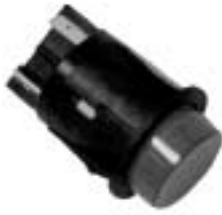
Interruptor cafetera, luminoso rojo. Pulsador bipolar. Ø 25 mm. 250V 16 Amperios.
